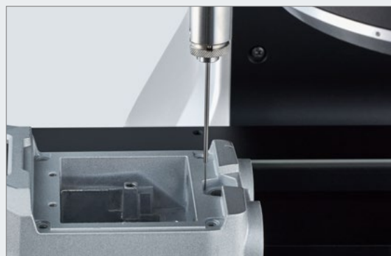
指定箇所が狭くても、自動で場所を認識して測定します。
