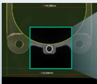
精度が必要な箇所だけ 高精度カメラに切り換え
