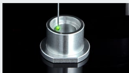
ライト部の接触をカメラで検知
