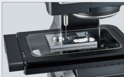
プローブが毎回同じ位置を認識して測定
